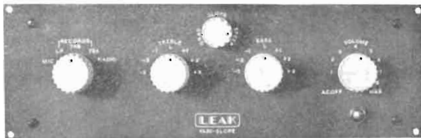
Fig. 7. - Aspetto frontale del preamplificatore Leak « Vari-Slope ». Da sinistra a destra: il selettore d'ingresso, il comando degli alti ( L = level , indica la posizione di risposta piatta), il regolatore graduale della pendenza della curva di attenuazione degli alti, il comando dei bassi, il regolatore di volume con incorporato l'interruttore generale dell'amplificatore.
